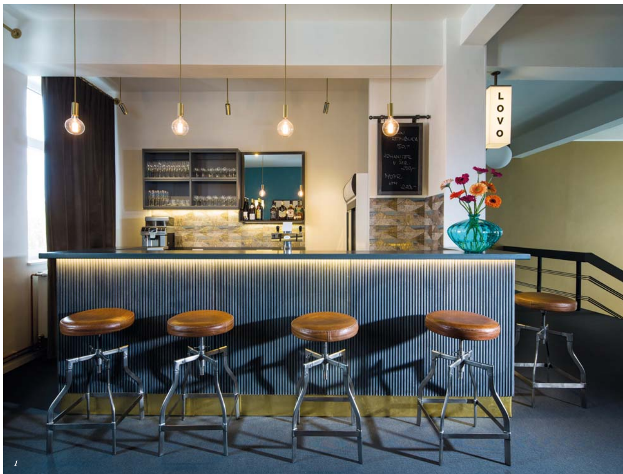
1 Nový bar vznikl v patře v místech, kde bývaly nepoužívané toalety. Odstranily se příčky a použily materiály pomáhající sjednotit celý objekt: betonový obklad a mosaz. 2 Součástí oživení kulturního střediska je mj. nová typografie a grafická identita, vznikající ve spolupráci se studiem HMD.
